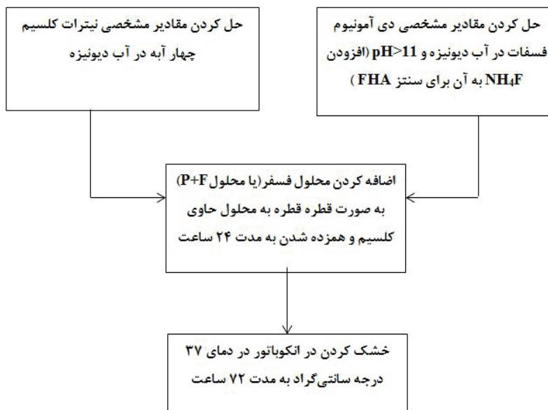
شکل ۲. نمودار سنتز پودر هیدروکسی آپاتیت و فلورهیدروکسی آپاتیت بدون انجام کلسیناسیون و از طریق تنظیم pH محلول
