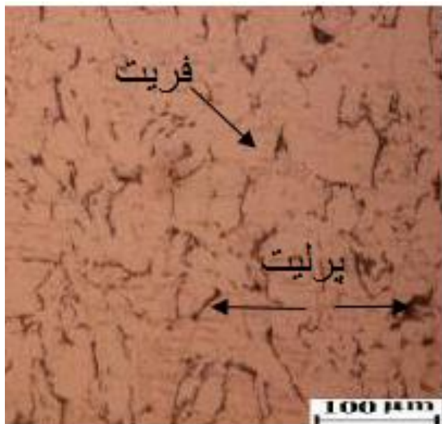
شکل ۲: ریز ساختار فولاد ASTM A106-Gr.B مورد استفاده.
