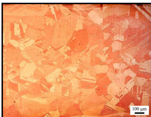
شکل ۱: تصویر ریزساختار فلز پایه قبل از عملیات حرارتی.
