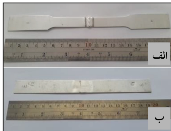
شکل ۱. نمایی از نمونه تهیه شده جهت آزمون: (الف) کشش، (ب) خمش.
