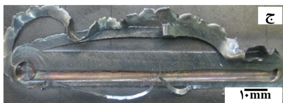
شکل ۱. تصاویر مربوط به سطح نمونه‌های جوشکاری شده در سرعت دورانی ۷۰۰ rpm و سرعت‌های پیشروی مختلف (الف) ۵۰ mm/min، (ب) ۱۰۰ mm/min و (ج) ۲۰۰ mm/min.
