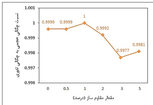
تصویر ۷. نسبت چگالی حجمی به چگالی تئوری نانوکامپوزیت‌های Al-Hybrid CNT/SiC w تولید شده در دمای ۵۵۰ °C و زمان ۴۵ دقیقه پرس گرم برحسب درصد مقاوم‌ساز.
