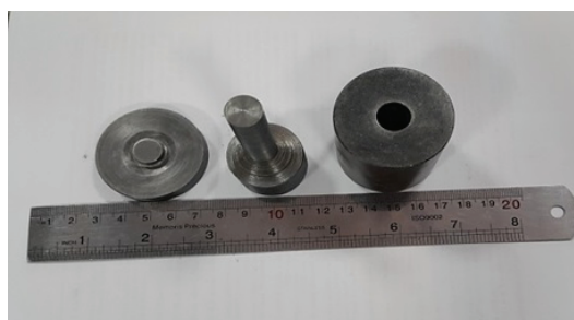
تصویر ۵. قالب پرس گرم مورد استفاده در پژوهش حاضر.
