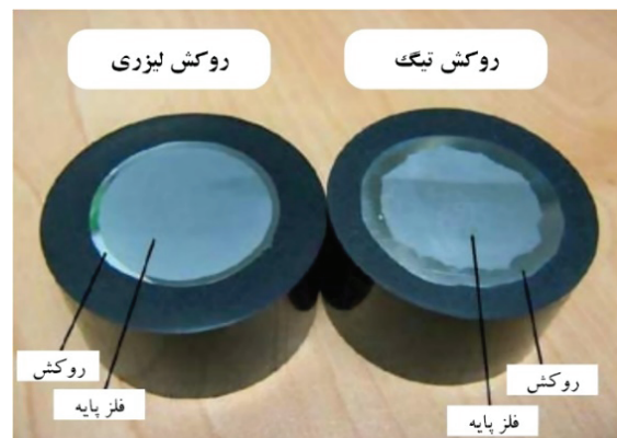
شکل ۵. اعوجاج ناشی از فرآیندهای روکش کاری تیگ و لیزر [۴۲].
