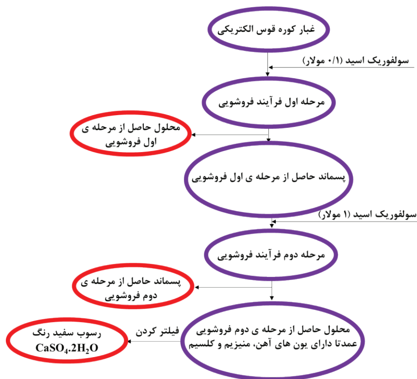
شکل ۱. فلوچارت فرآیند لیچینگ غبار کوره قوس الکتریکی.
