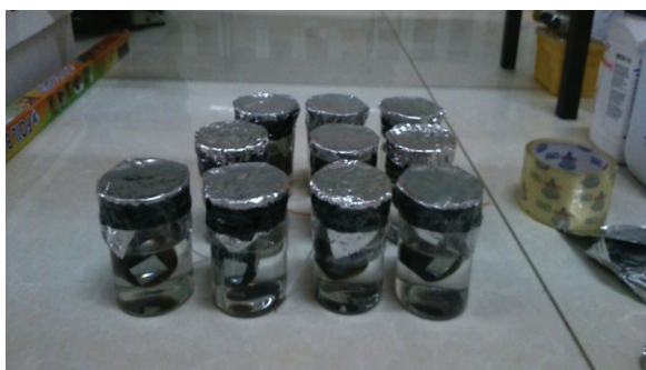
شکل ۱. قرارگیری نمونه‌ها در محلول شبیه‌سازی شده استریل و تلقیح شده با باکتری.
