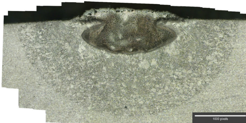
شکل ۷. تصاویر میکروسکوپی نوری از مقطع عرضی حوضچه مذاب نمونه (200-1000) S4.
