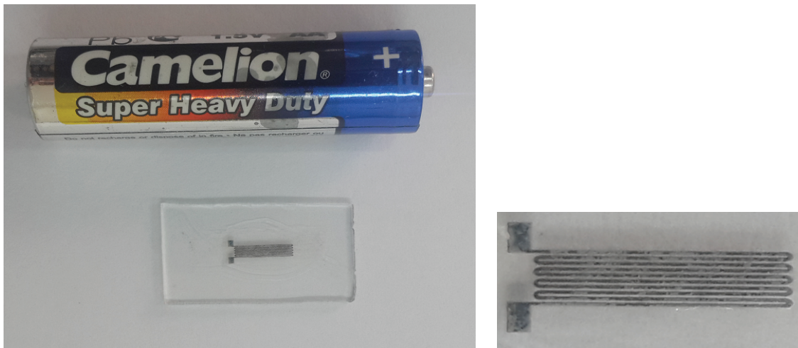
شکل ۲. تصویر نمونه با طرح مارپیچی حاصل از لیتوگرافی و فرآیند اچ.
