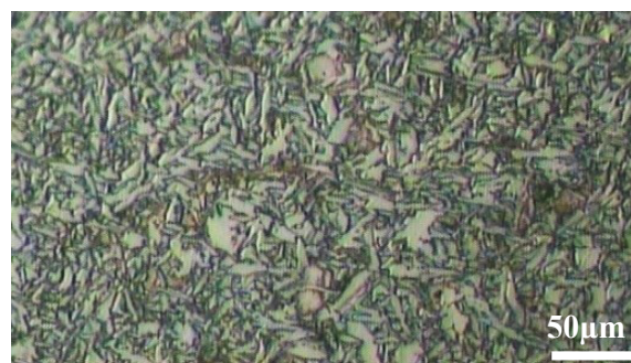
شکل ۲. ریزساختار نوری روکش جوشی نمونه Cr-L.
