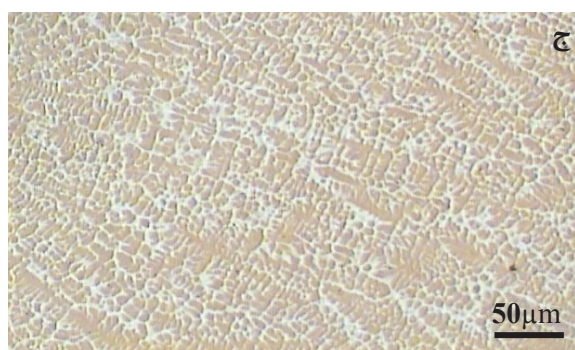
شکل ۳. ریزساختار نواحی مختلف روکش‌های ایجاد شده توسط الکتروود Cr-M و Cr-H. (الف) ناحیه فصل مشترک نمونه Cr-H، (ب) سطح فوقانی نمونه Cr-M، (ج) سطح فوقانی نمونه Cr-H.
