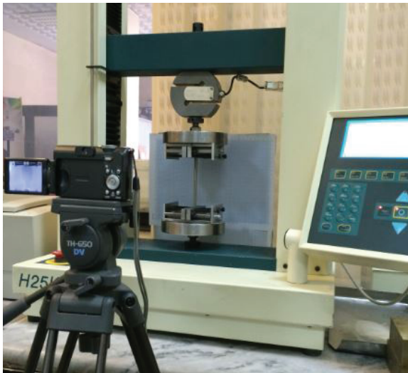
شکل ۱. دستگاه آزمون کمانش
