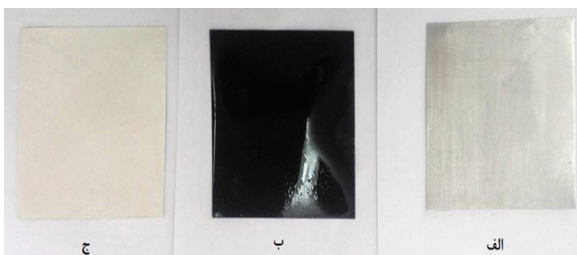
شکل ۲. تغییرات سطح آلومینیوم در اثر فرآیند اچ کردن
