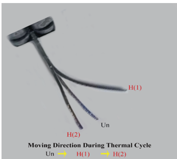
شکل ۱۲. تصاویر نمونه پس از باربرداری (Un) و پس از حرارت دهی (H(1)) و (H(2)).
