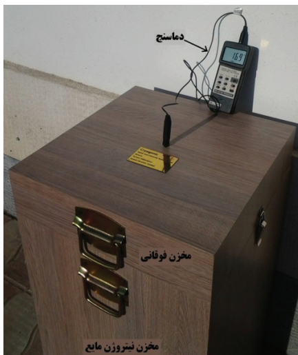
شکل ۱. دستگاه عملیات زیرصفر ساخت دانشگاه آزاد اسلامی واحد آیت الله آملی
