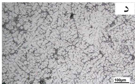
شکل ۵. تصاویر میکروسکوپ نوری الف: زمینه A356 ب: ۰/۵٪ ج: ۱٪ د: ۱/۵٪ در بزرگنمایی ۲۰ برابر
