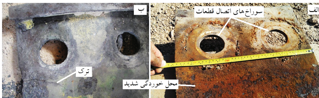
شکل ۲. الف) نمایش محل خوردگی و سوراخ‌های اتصال قطعات به یکدیگر در یک قطعه ایمرژن تیوب و ب) نمایش یک ترک ایجاد شده در قطعه ایمرژن تیوب ناشی از عوامل تنشی و خوردگی.
