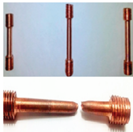
شکل ۴. الف) نمونه‌های آماده‌سازی شده قبل از آزمون کشش، ب) نمونه بعد از آزمون کشش.
