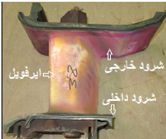
شکل ۱. تصویر نازل ردیف اول توربین گاز زیمنس از جنس سوپر آلیاژ IN738LC با ۳۳۰۰۰ ساعت کارکرد معادل
