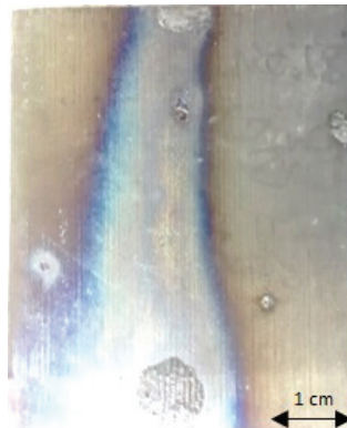
شکل ۲. الف) سطح نمونه جوشکاری شده با فلاکس فعال ZnO (ب) پشت نمونه جوشکاری شده با فلاکس فعال ZnO.
