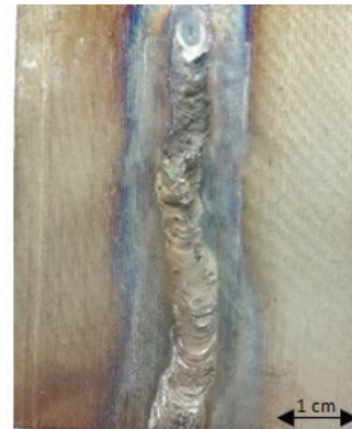
شکل ۲. الف) سطح نمونه جوشکاری شده با فلاکس فعال ZnO (ب) پشت نمونه جوشکاری شده با فلاکس فعال ZnO.
