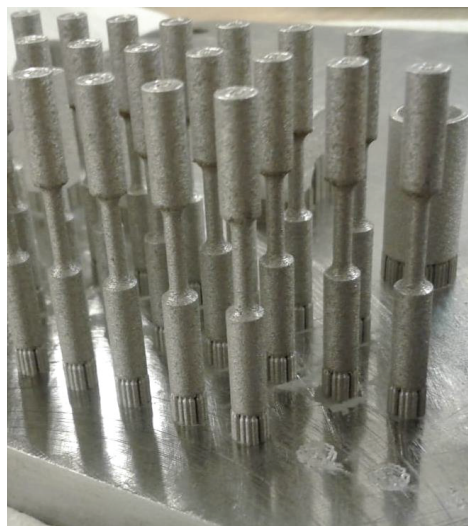
شکل ۱. تصویر نشان دهنده نمونه‌های آزمون کشتش تولیدی به روش ساخت افزایشی.
