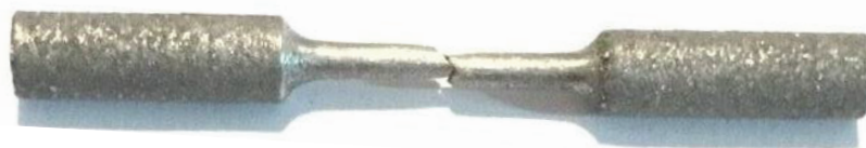
شکل ۷. محل شکست نمونه آزمون کشش.
