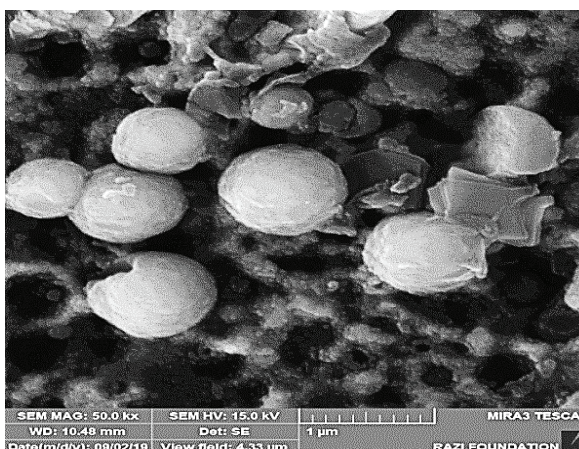
شکل ۲. تصویر میکروسکوپ الکترونی روبشی نشر میدانی از ریزساختار نمونه پیرسازی شده در دمای ۸۰۰ °C و زمان ۲۳ ساعت.
