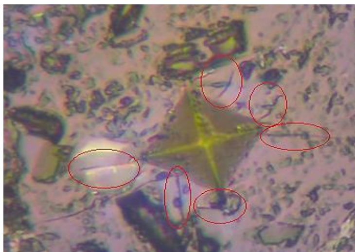
شکل ۴: نمونه‌ای از تصویر میکروسکوپ نوری برای اندازه‌گیری طول ترک برای محاسبه چقرمگی مطابق روش نیهارا
