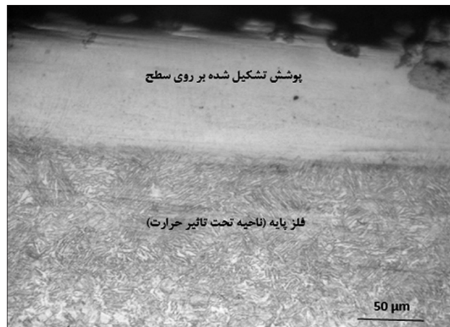
شکل ۴- تصویر میکروسکوپ نوری از پوشش تشکیل شده بر روی سطح
